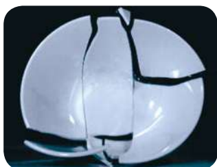
(1/2000秒の世界) 強化磁器破壊の瞬間
